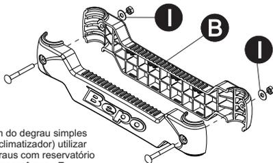
OBS: Para montagem do degrau simples (sem reservatório de climatizador) utilizar parafusos «F» e degraus com reservatório de climatizador utilizar parafusos «E».
